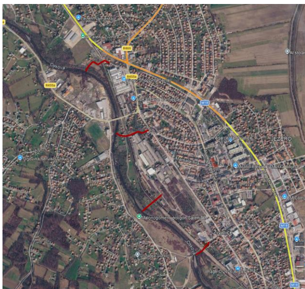
Predložene lokacije cjevovoda za odvodnju oborinskih voda i separatora ulja i masti
