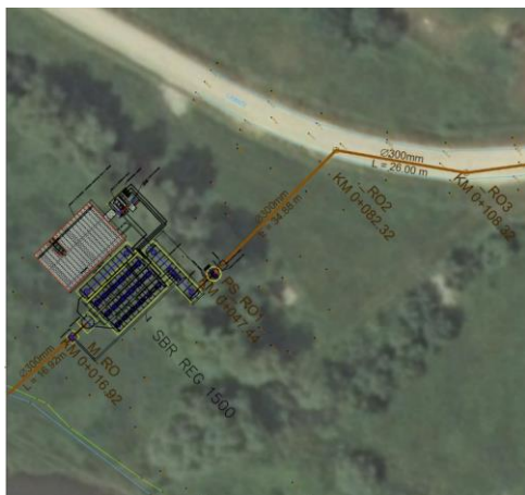
Planirani raspored uređaja za prečišćavanje otpadnih voda
